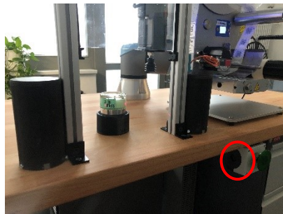
Bereit-LED leuchtet nicht, da der Glastiegel nicht korrekt ausgerichtet ist
